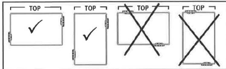
Mindestens zwei Belüftungselemente pro Gehäuse
